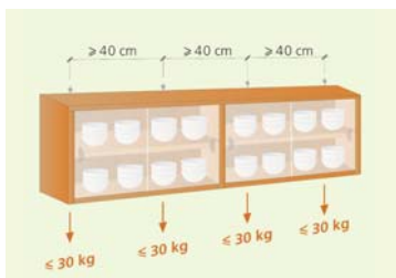
Figura 2: Reparto de la carga.
