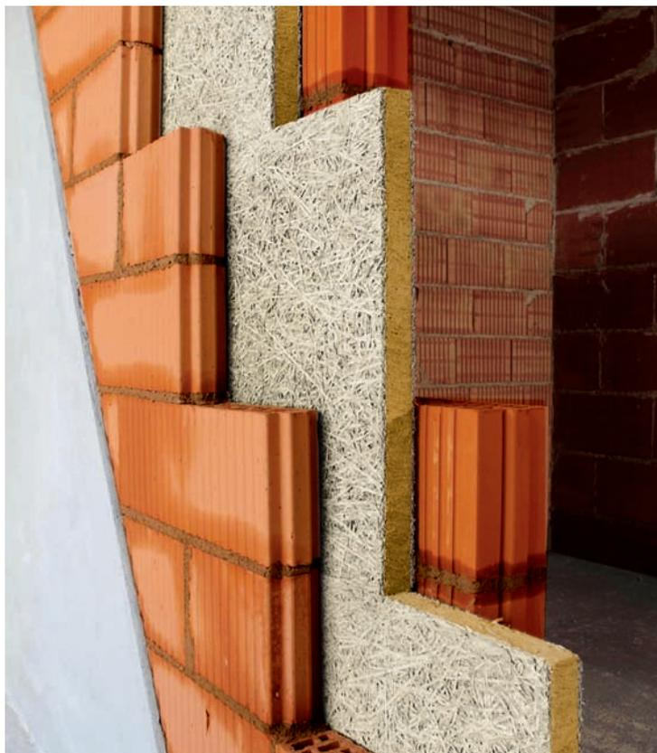
Panel sándwich compuesto por dos estratos de 5 mm de espesor cada uno, de viruta gruesa de madera de abeto, aglomerado con cemento Portland gris, firmemente adheridos a un estrato interno de lana de roca de alta densidad, orientada e incombustible.
